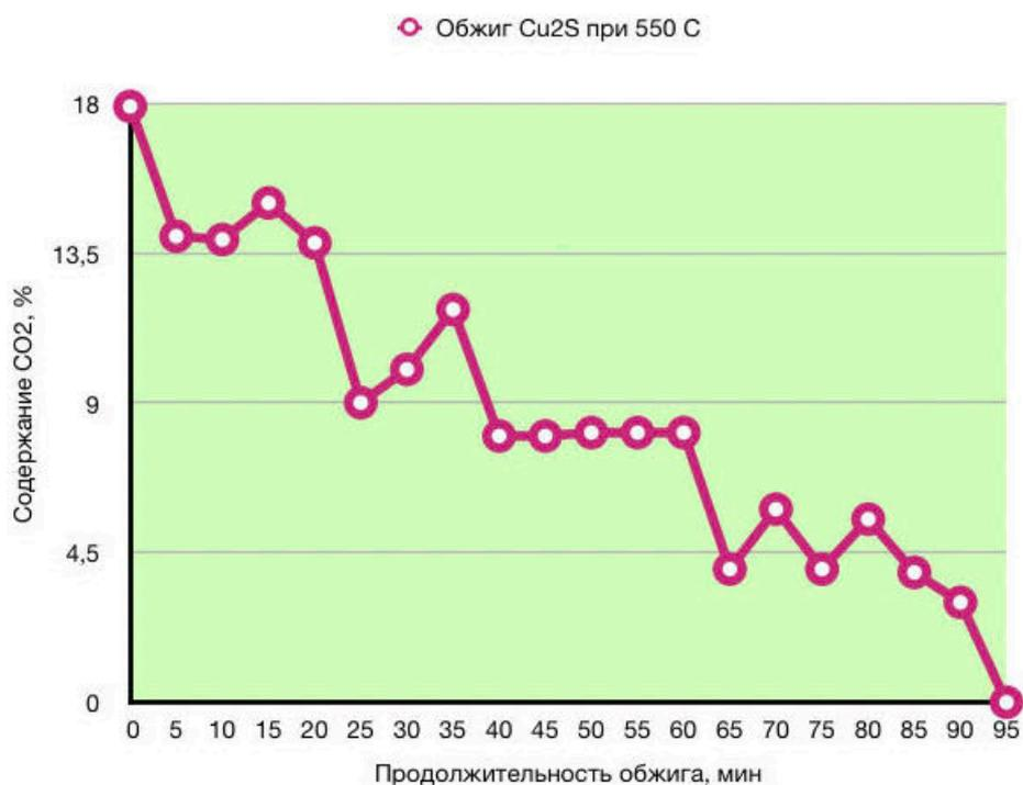
Рисунок 3.3 – Содержание CO<sub>2</sub> в газах реактора при обжиге сульфида меди при температурах 550<sup>0</sup>С
